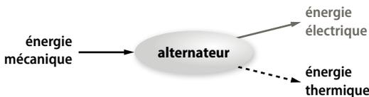
$$2. \eta = \frac{E_{\text{électrique}}}{E_{\text{mécanique}}} = \frac{1,3}{1,4} = 0,93.$$
