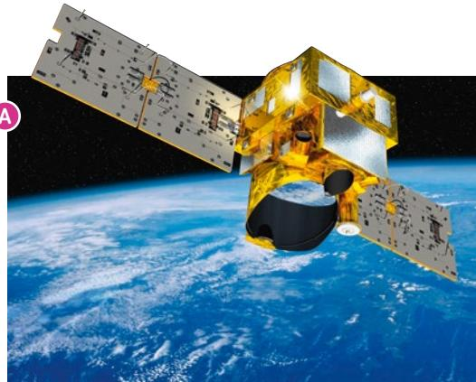
Der deutsch-französische Satellit MERLIN soll ab 2024 in der Erdatmosphäre die Methankonzentration messen<sup>1</sup>, die für die Klimaerwärmung mitverantwortlich ist. Die Forscher wollen mit den Resultaten ein effizientes Konzept für den Klimaschutz entwickeln.
